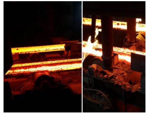
Şekil 2. Soğuma boyunca kütük üzerinde oluşan tufal tabakası
