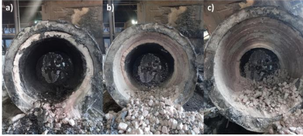
Şekil 5. a) Ağız bölgesi, b) orta bölge ve c) taban-duvar birleşim bölgesinde kalan astar kesitleri
